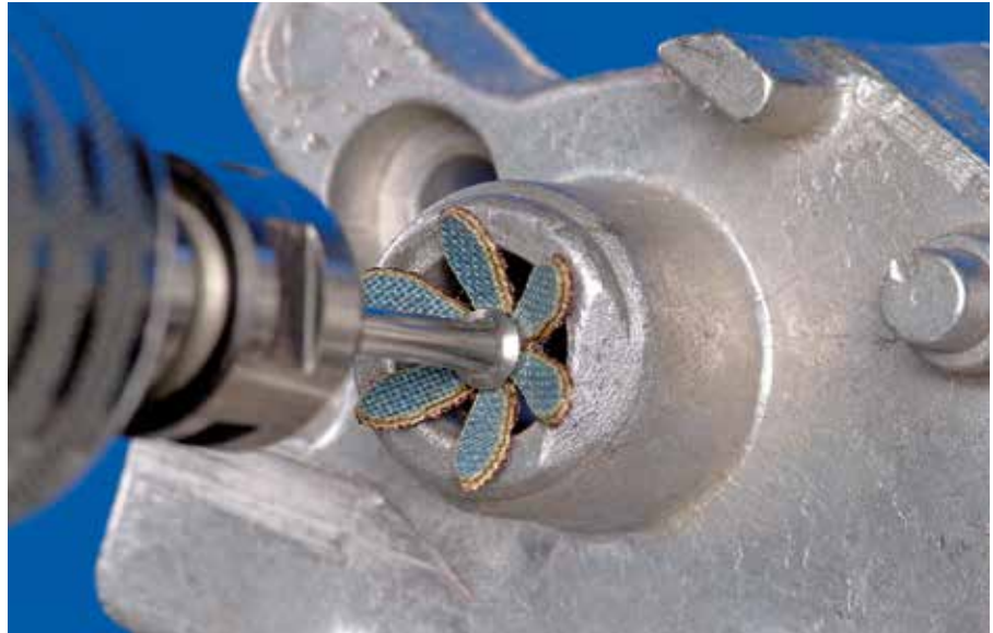
optimal zum Entgraten von Bohrungen etc.
