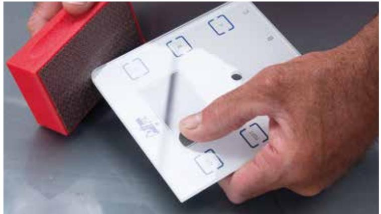
Pour usiner des plaques de granit, encore plus efficace si on travaille à l'eau
