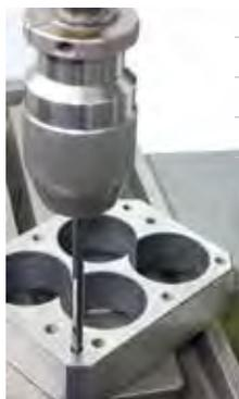
Vitesse de coupe recommandée :  $V_c = 15 \text{ à } 30 \text{ m/min}$
