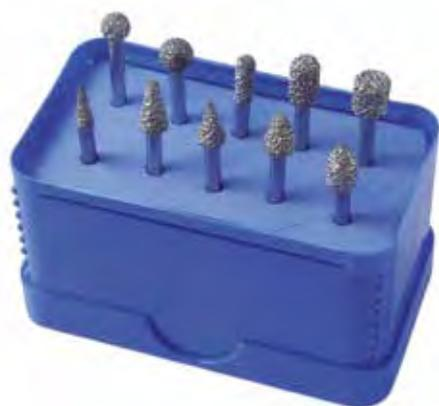
Le kit se contient 10 meules sur tige diamantée, liant vacuum brazed, grain D 427, queue Ø 3 x 55 mm :
