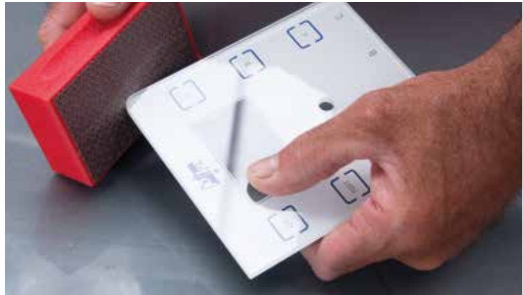
Abrunden/Bearbeiten von Glasoberflächen
