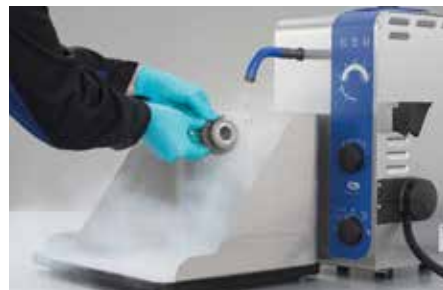
Reinigen in der Abdampfschale
