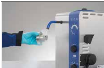
Reinigen mit fester Düse und Fußpedal
