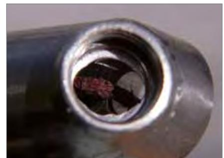
Bearbeitung von Bohrungsdurchgängen
