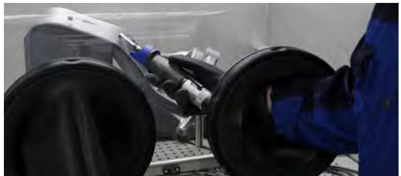
De plus grandes ouvertures pour les mains améliorent l'ergonomie du poste de travail
