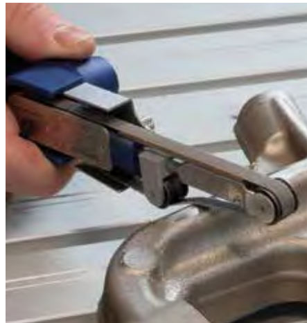
Formes convexes - Machine de meulage à bande et bandes de meulage
