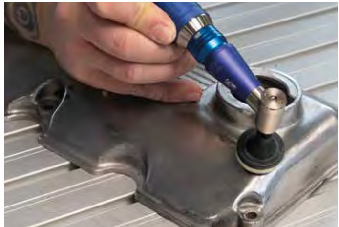
Polissage d'aluminium avec pièce à main d'équerre et feutre
