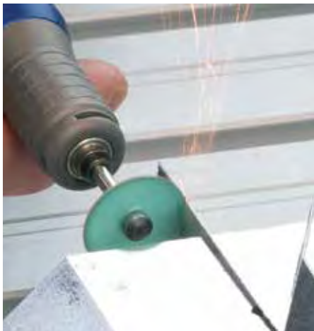
Coupe froide avec disque à tronçonner en fibre céramique
