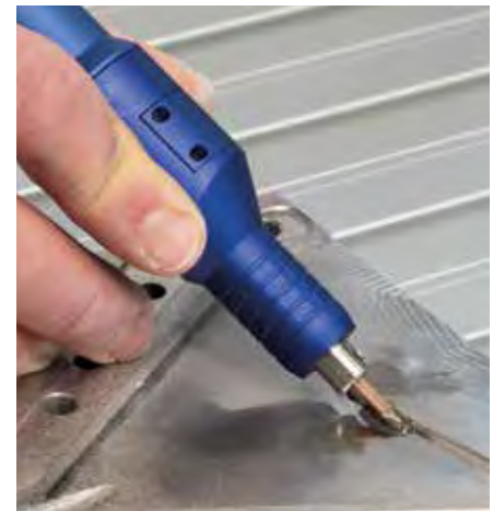
Bois de polissage avec pâte diamantée et machine à limer à main
