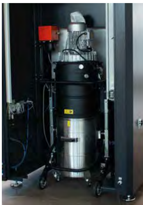
Système d'aspiration facilement accessible par l'arrière
