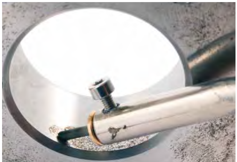
Revêtement en carbure de tungstène d'une pièce
