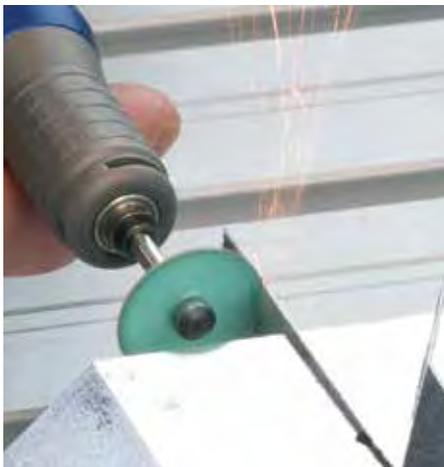
kühler Schnitt mit Keramikfaser-Trennscheibe
