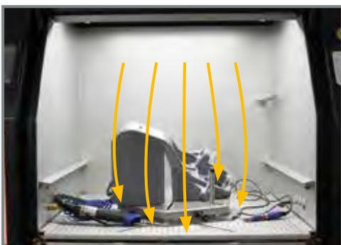
Durch eine strömungstechnisch optimierte Luftführung werden die gefährlichen Stäube in Absaugrichtung gelenkt.
