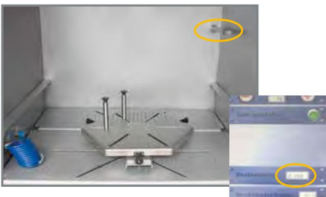
Die Anlage kann mit der speziellen Feinstaub-Messautomatik FSX ausgestattet werden. Die Staubbelastung wird permanent im Arbeitsraum gemessen und über das Display angezeigt.
