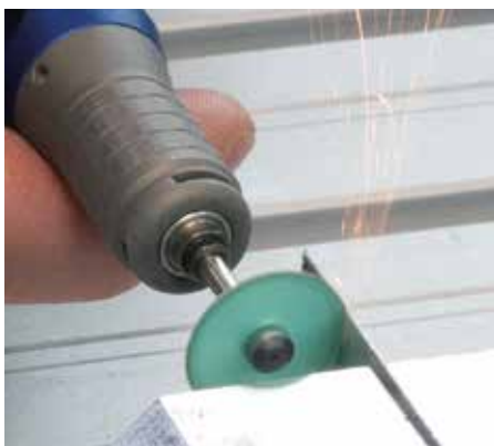
kühler Schnitt mit Keramikfaser-Trennscheibe
